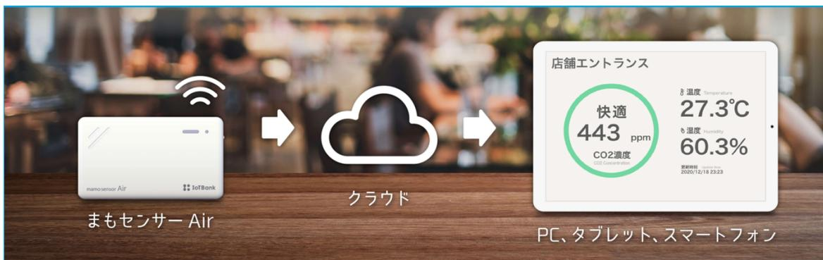
まもセンサー Airの仕組みと表示例
